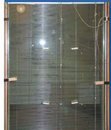
sGG CLIMAPLUS SCREEN in der Prüfkammer
