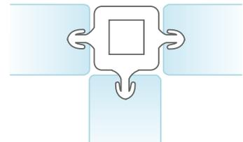
Die innovativen CLIP-IN Verbindungsprofile lassen sich schnell und unkompliziert montieren und bei Änderungen rückstandslos wieder abbauen. Damit bieten sie optimale Möglichkeiten für die flexible und attraktive Raumgestaltung – in Verbindung mit kurzen Montagezeiten und einer schnellen Bauabwicklung.
